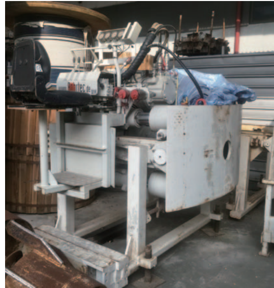
用於頂管施工的螺旋鑽孔機
